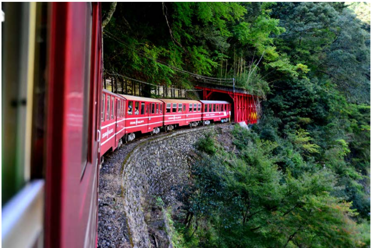
1000 分の 90 という日本一の急勾配を走る電車を後方から押して行くアプト式電車
