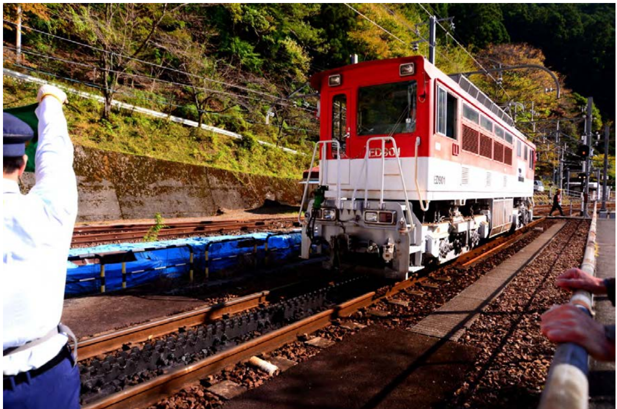
1000 分の 90 という日本一の急勾配を走る電車を後方から押して行くアプト式電車
